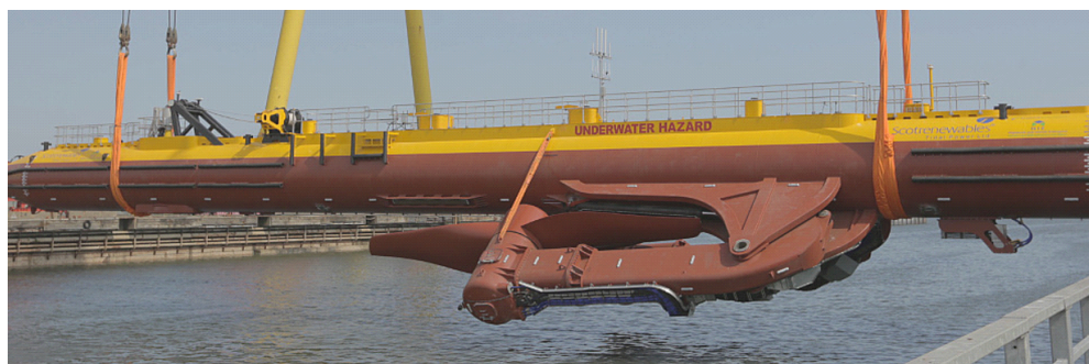
実際の SR2000 の浮体（船体）に収納されている直径 16m の発電ローター
